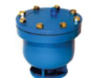
**ВАНТУЗ** предназначен для автоматического удаления воздуха при его накоплении, а также для его автоматического впуска при образовании вакуума в системах холодного водоснабжения при давлении от 0,1 МПа до 1,0 МПа (от 1 кгс/с м<sup>2</sup> до 10 кгс/с м<sup>2</sup>) в диапазоне температур от + 5°С до + 50°С. Масса Вантуза Ду 50 — 28 кг; Ду 100 — 37 кг. Материал корпуса: чугун.
