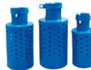
**ИСКРОГАСИТЕЛИ** служат для предотвращения выброса искр продуктов двигателей внутреннего сгорания. Устанавливаются на выхлопные трубы различной спецтехники, работающей на местности с высокими требованиями к пожарной безопасности. Диаметры искрогасителей находятся в диапазоне от 45 до 210 мм. Материал изготовления искрогасителя – сталь, перфорированная с внешней стороны. Температурный диапазон эксплуатации от – 40° С до + 55° С.
