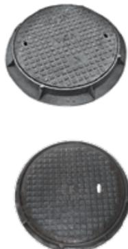
**КАНАЛИЗАЦИОННЫЙ ЛЮК ЧУГУННЫЙ ТИПА Т** (тяжелый) устанавливается на автодорогах с интенсивным движением. Номинальная нагрузка на крышку люка – 25 тн; основание: 800 x 90 мм; крышка: 645 x 40 мм, вес 90 кг.
