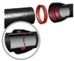
**МАНЖЕТА ТАЙТОН** Ду 80, 100, 150, 200, 250, 300, 400, 600 мм – уплотнительное резиновое кольцо – обеспечивает стыковое раструбное соединение, не является жестким и позволяет отклоняться соединенным трубам на угол от 1,5° до 5° в зависимости от диаметра труб при сохранении полной герметичности стыка. Диапазон применения – холодное водоснабжение, канализация.
