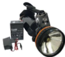
**ФОНАРЬ ФОС 3-5/6** состоит из поворотной фары, соединенной с цилиндрическим корпусом. Фара поворачивается относительно горизонтальной оси на угол 120 градусов. В комплект поставки входит: галогенная лампа, аккумулятор, ремень наплечный, паспорт. Предназначен для работы на суше и на море. Корпус и фара выполнены из прочного пластика и выдерживают удары при падении с высоты 2 м. Время работы, не менее – 4,5 ампер/часов. Вес – 1,6 кг.
