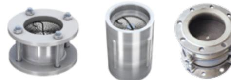
**ОГНЕПРЕГРАДИТЕЛИ ОП И ПЛАМЯПРЕГРАДИТЕЛИ ПП И ПОЖ-80** предназначены для предотвращения проникновения искр и пламени в резервуар при воспламенении паров нефти и нефтепродуктов. Действие огнепреградителя основано на поглощении тепла пламени или искры материалом кассеты. Конструкция – сборно-разборная.
