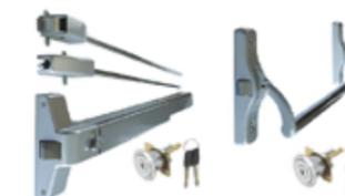
**СИСТЕМА «АНТИПАНИКА»** обеспечивает беспрепятственный выход из помещения в случае экстренной эвакуации без использования ключа. Снаружи замок «Антипаника» открывается ключом, изнутри – путем нажатия на ручку-штангу (TOUCH BAR) или ручку-клавишу (PUSH PAD). Все детали замка «Антипаника» являются огнеупорными, т.е. не плавятся даже при достаточном высоких температурах.
