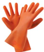
■ **ПЕРЧАТКИ ДИЭЛЕКТРИЧЕСКИЕ** – основное средство индивидуальной защиты человека от поражения электрическим током напряжением до 1000 В, а при контакте с электрическим током напряжением в интервале от 1000 В до 15000 В – дополнительное средство индивидуальной защиты. Бывают шовные и бесшовные. Один раз в 6 месяцев перчатки подлежат переосвидетельствованию.
