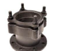
**ПАТРУБОК (СОЕДИНИТЕЛЬНЫЙ УЗЕЛ) ПФРК** служит для соединения гладких концов труб диаметром от 50 до 1400 мм с задвижками и прочей фланцевой арматурой, а также для фланцевых соединений труб, изготовленных из стали и чугуна. Состоит из корпуса (чугун), сальника (резина), шпилек и гаек.
