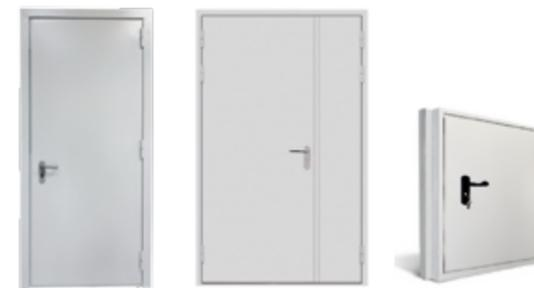
Двери противопожарные изготавливаются в следующих исполнениях: однопольные и двухпольные; с правым и левым открыванием; с порогом и без порога; с наличником и без наличника; глухие и с остеклением до 25% площади; любой цвет по таблице RAL.
