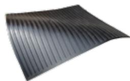
■ **КОВРЫ ДИЭЛЕКТРИЧЕСКИЕ** (500x500 мм, 750x750 мм) применяются в качестве дополнительного защитного средства в закрытых электроустановках напряжением свыше 1000 В, кроме особо сырых помещений, и открытых электроустановках в сухую погоду. Ковры имеют рифленую лицевую поверхность с глубиной рифов 1–3 мм. Срок поверки – 36 месяцев.
