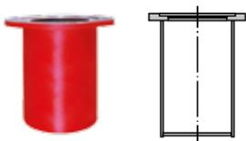
**ПОДСТАВКА ПОЖАРНАЯ ППС** – отрезок трубы диаметром 219 мм, длиной 350 мм с обратным фланцем, на который прикручивается пожарный гидрант. Применяется, когда необходимо установить пожарный гидрант в водопровод меньшего диаметра. Масса не более 22 кг.
