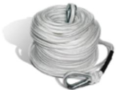
**ВЕРЕВКА ПОЖАРНАЯ СПАСАТЕЛЬНАЯ (ВПС)** предназначена для страховки пожарных при тушении пожаров и проведения связанных с ними аварийно-спасательных работ. Длина веревки ВПС-30 составляет не менее 30 м, ВПС-50 составляет не менее 50 м. Диаметр веревки – 11 мм. Масса веревки: ВПС-30 не более 2,7 кг; ВПС-50 не более 4,5 кг.
